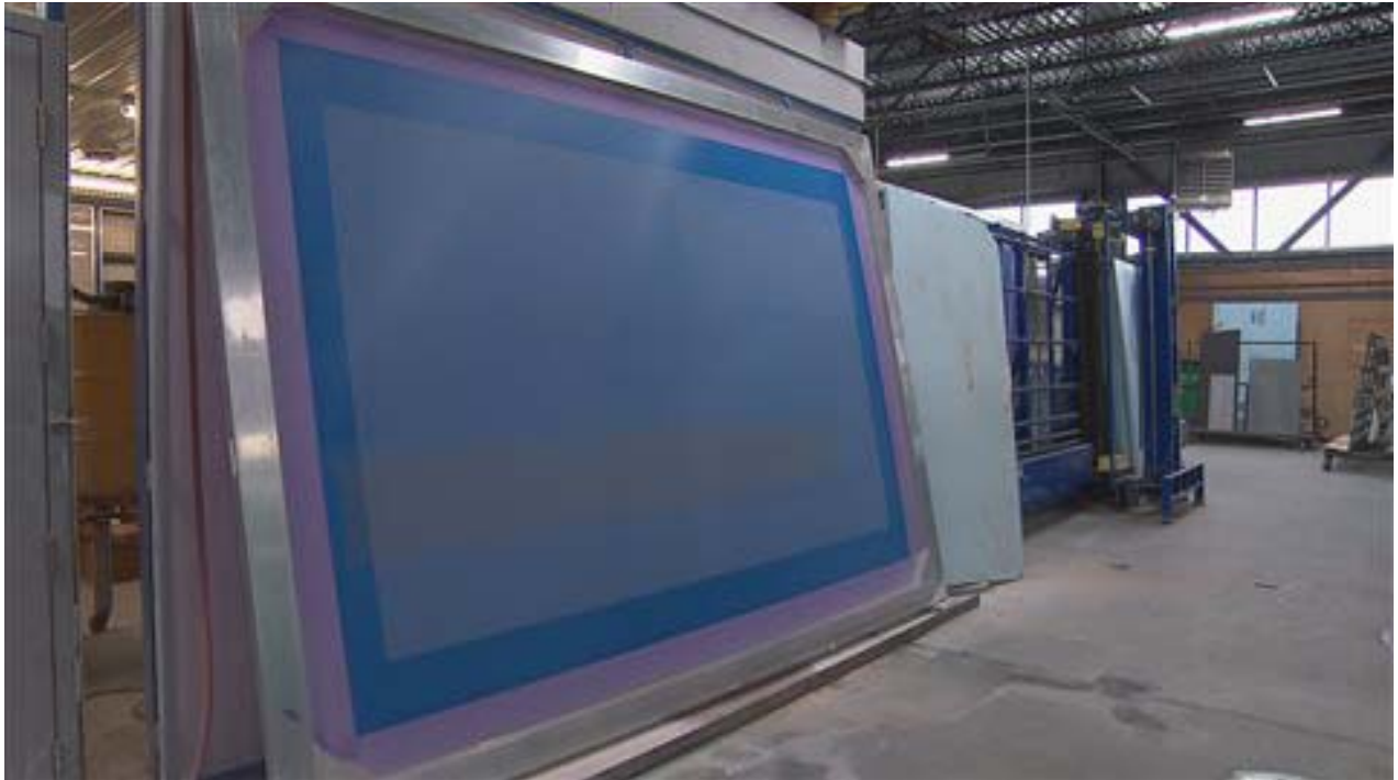
Un modèle ayant servi à la préparation des motifs sur les panneaux de verre du pavillon Pierre Lassonde PHOTO : RADIO-CANADA
